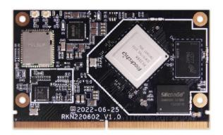
Компьютерный модуль формата SMARC 2.1 на базе ЦП RK3568
